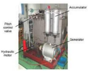
Ilustración 160 – Foto del sistema hidráulico
