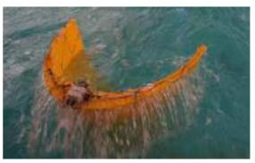
Ilustración 110 - Dispositivo CCell OWSC
