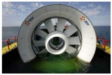
Ilustración 15 – Turbina OpenHydro
