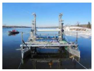
Ilustración 30 – Prueba de flotabilidad de turbina Mi1 en Canadian Hydrokinetic Turbine Test Centre (CHTTC) <sup>30</sup>
