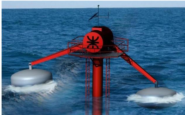
Figura 27. Dispositivo undimotriz UTN BA-FRBA. Fuente: <http://www.mecanica.frba.utn.edu.ar/energiaundimotriz>
