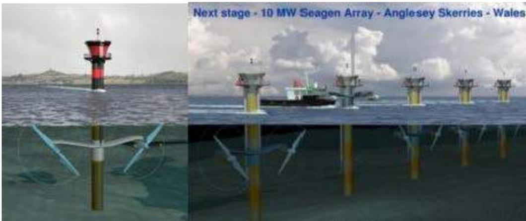
Ilustración 152 – Próximo paso: granja Seagen de de 10 MW
