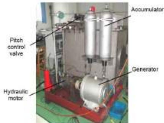
Ilustración 160 – Foto del sistema hidráulico
