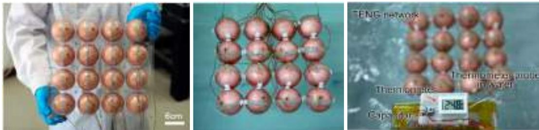
Ilustración 107 - Esferas enlazadas En el agua Generando con las olas
