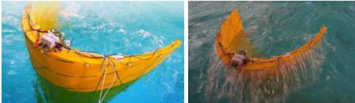
Ilustración 110 – Dispositivo CCell OWSC
