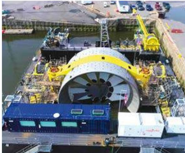
*Ilustración 14 - Turbina Cape Sharp Tidal de 2MW en el puerto después de una recuperación exitosa*
