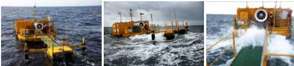
Ilustración 118 - Ocean Energy Buoy
