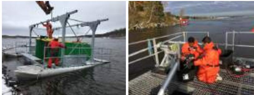
Ilustración 158 – Izq.: Turbina Avidson-Hill Venturi de Apex Global Power Corporation. / Der.: Instalación de prueba de la turbina Davidson-Hill Venturi de Apex Global Power Corporation<sup>134</sup>
