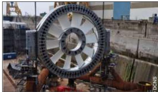
Figura 15. Turbina L'Arcouest de OpenHydro (Power Tecnología, s.f.a).
