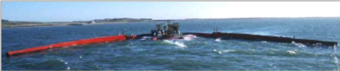
Figura 30. Prototipo (1:4,5) del Wave Dragon en el norte de Dinamarca. (Fernández Díez, s.f.e).
